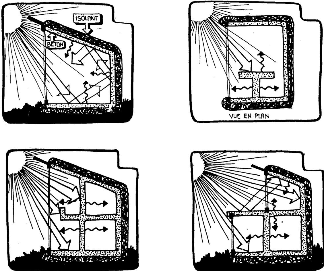
Figure 2.3 - Inertie et surface d'échange
