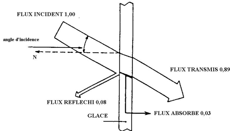
Figure 2.8 - Transmission lumineuse à travers un vitrage
