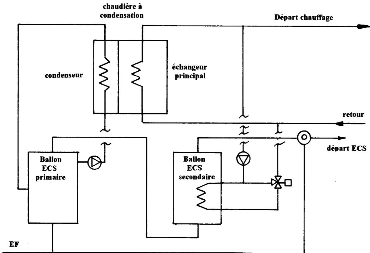
Figure 4.1 - Irrigation du condenseur par l'arrivée EF de la production ECS
