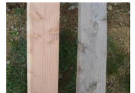
Fig.11: Le bardage trois ans après la mise en œuvre
